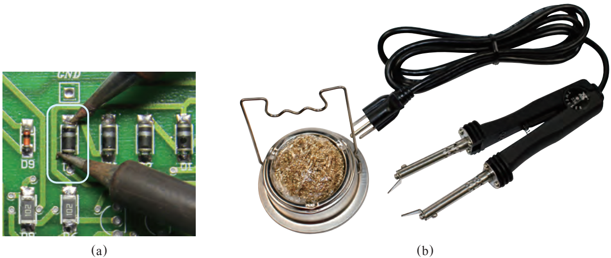
▲圖 3-13 兩個端點的表面黏著元件拆除要領
