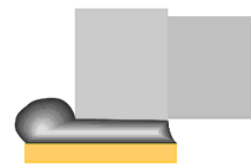
(c) 焊錫浸潤不足
