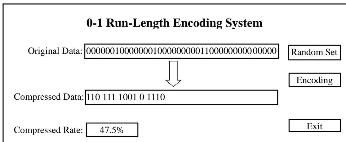
範例：如下圖所示，當系統執行初始狀態時，Original Data 顯示 36 個 0 與 4 個 1 所隨機組成
