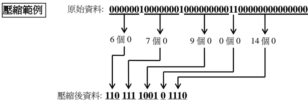
2.請依說明 1，設計如下圖所示之 0-1 變動長度編碼系統 (0-1 Run-Length Encoding System)，使其具有下列功能：
